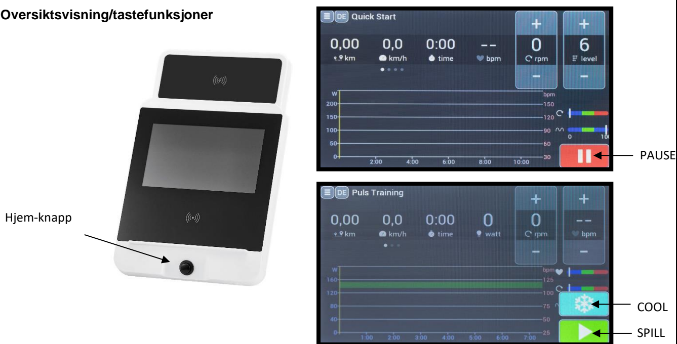
Fig. 9: Skjermvisning, forklarer knappefunksjonene, den faktiske visningen kan variere i farge, knappetilordningen er den samme.
