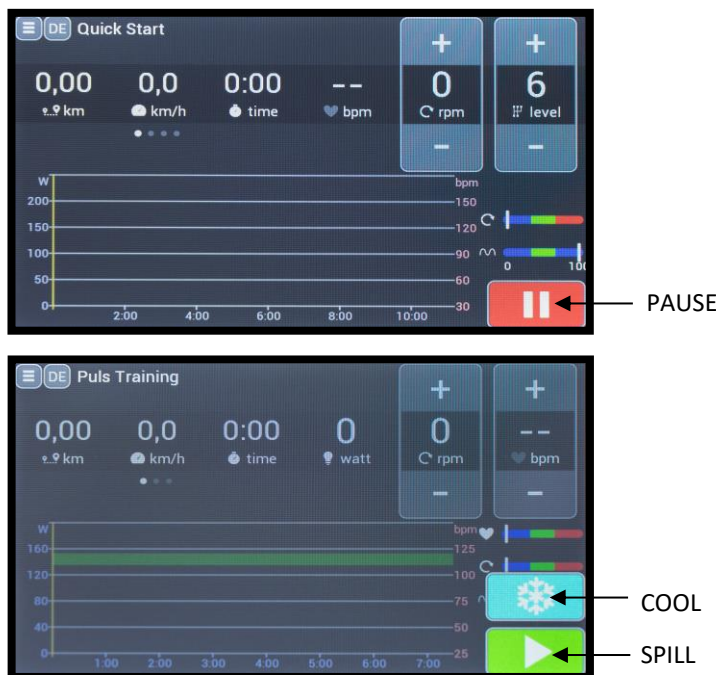
Fig. 2: Skjermvisning som forklarer knappefunksjonene, den faktiske visningen kan variere i farge, knappetilordningen er den samme.
